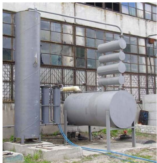
СИСТЕМА РЕКТИФИКАЦИИ И СТАБИЛИЗАЦИИ ДАВЛЕНИЯ
