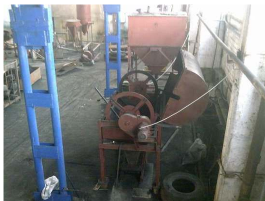
ГРОХОТ С СИСТЕМОЙ МАГНИТНОЙ СЕПАРАЦИИ
